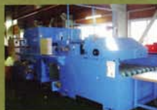
SU-1400 平版の木型により抜き加工を 連続して行います
