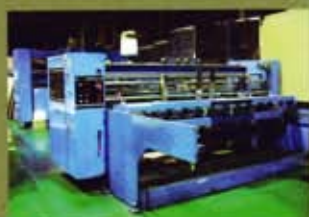
FGR-9N 2700 タイプ 連続して開付け、結束をします
