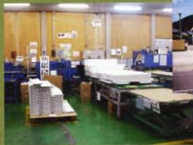
I.P.S. PACK 自動梱包ライン 自動給紙、自動刷り込み、ホットメルト接着 で梱包を連続して行います
