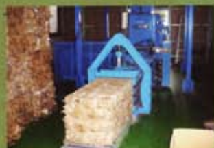
ペーラー TB0-100 段ボール古紙をプレスして ブロックにします
